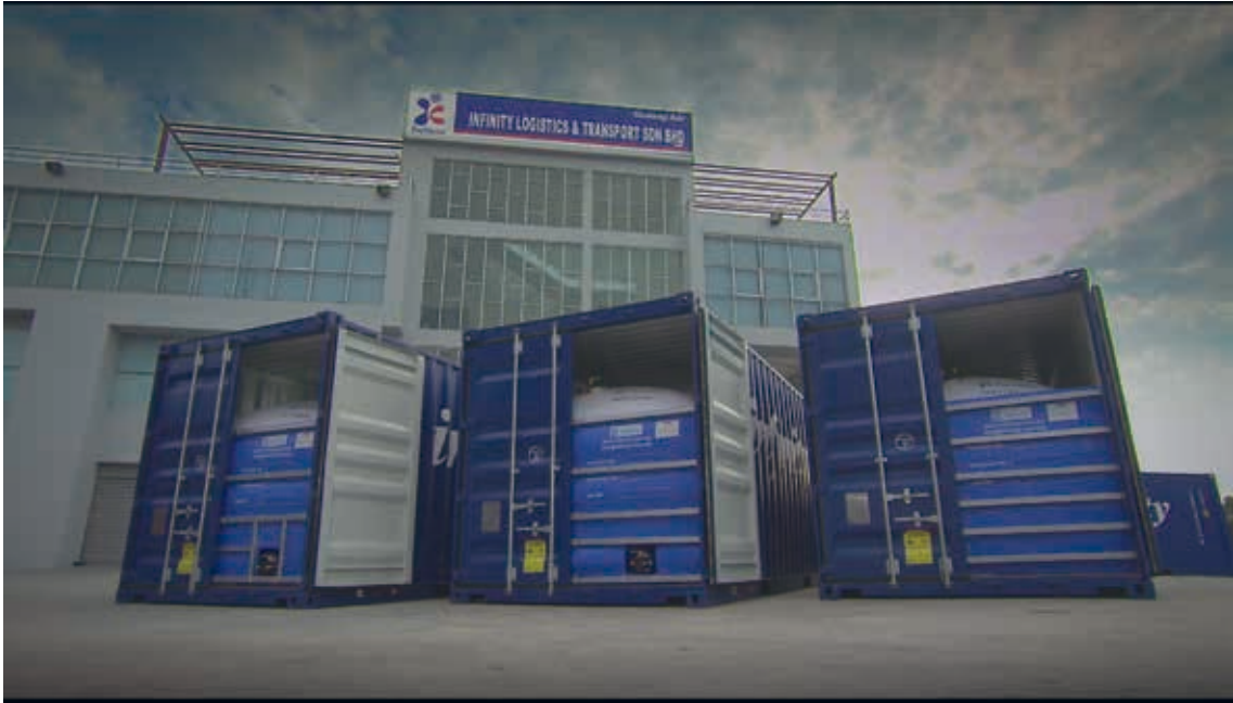
一 集裝箱內裝設及安裝的已裝載貨物的集裝箱液袋(集裝箱已安裝隔板)
